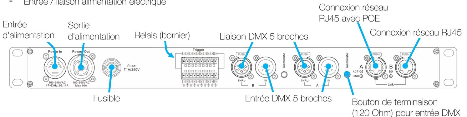
Connexion réseau RJ45 avec POE
