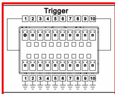
10 entrées sont prévues et peuvent être connectées avec diverses fonctions du RDM10. Les entrées sont de simples fermetures à contact sec sous la forme de dix paires de connexions de déclenchement et de mise à la terre.
